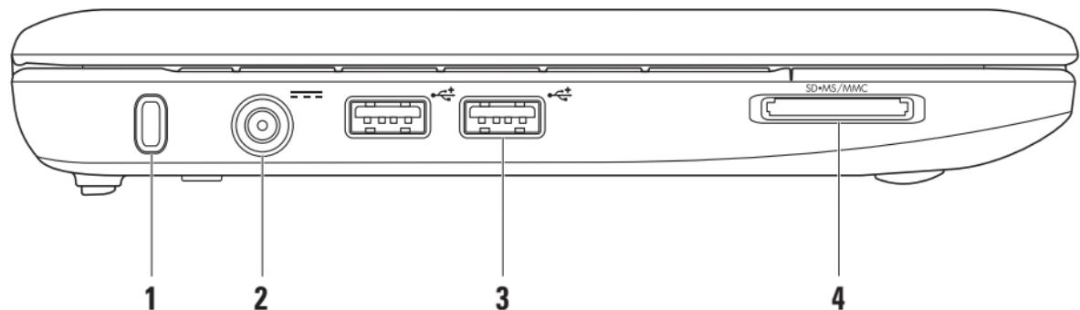
**1 Utora za sigurnosni kabel** – Priključuje komercijalno dostupne protuprovalne uređaje na računalo.
